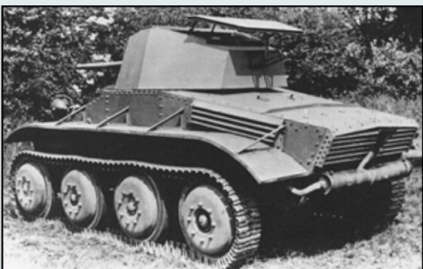
De foto toont duidelijk het motorcompartiment met de 12 cilinder, 165 pk Meadows motor. Ook goed zichtbaar is de manier waarop het luik in de koepel open gaat.
