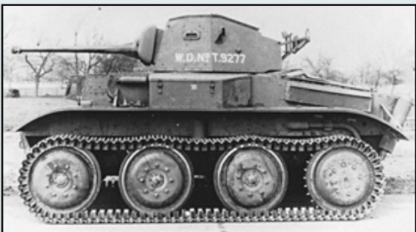
Zijaanzicht van de Tetrarch. De vier wielen zijn volkomen identiek. Het aandrijfwieltand onderscheidt zich alleen door de tanding en de wijze waarop het aan de romp is bevestigd.
